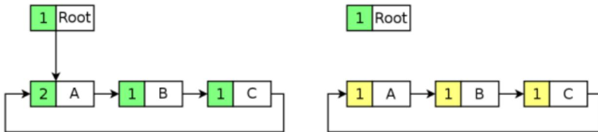
Figura: Ciclos en conteo de referencias requieren recolector
